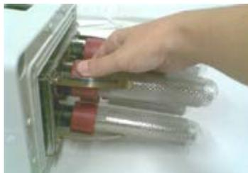
5. Sfilare la rete (R) esterna al tubo: se l'operazione risulta difficoltosa, ruotare leggermente la rete attorno al condensatore al quarzo.
